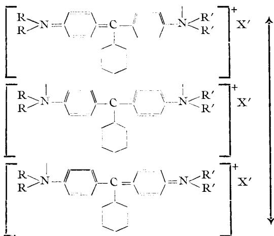
Intensiv farbiges Kation eines basischen Triphenylmethan-Farbstoffes; unbehindertes „merichinoides Alternieren“. Die Carbeniumformel ist Durchgangsstation der Elektronenbewegung, deren Grenzen die chinoiden Formeln sind. Besetzung der „Lücken“ am C oder an den N-Atomen hebt die Resonanzmöglichkeit und damit die Farbe auf (Einfärbung von Aminen bzw. Addition von Säure).
